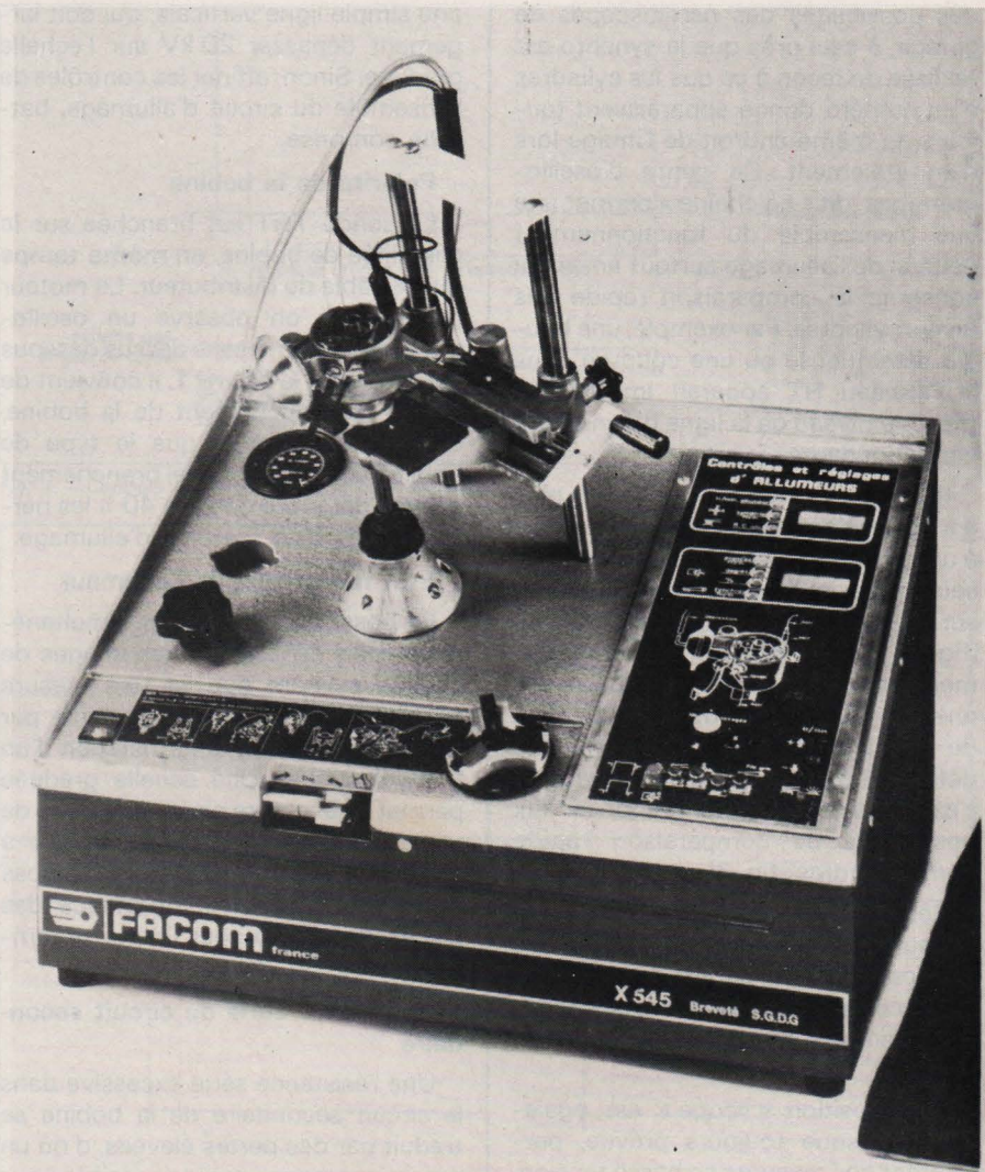
Un banc d'allumeurs permettant une vérification et un réglage de tout allumeur déposé. L'affichage des résultats se fait en numérique 7 segments (cliché Facom).
