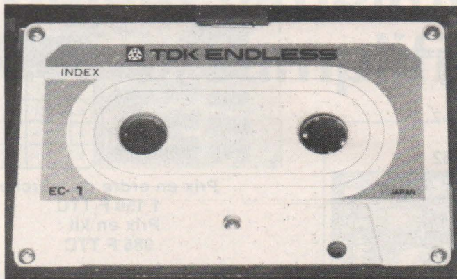
Une cassette sans fin permet de renouveler l'appel aussi longtemps que nécessaire.
