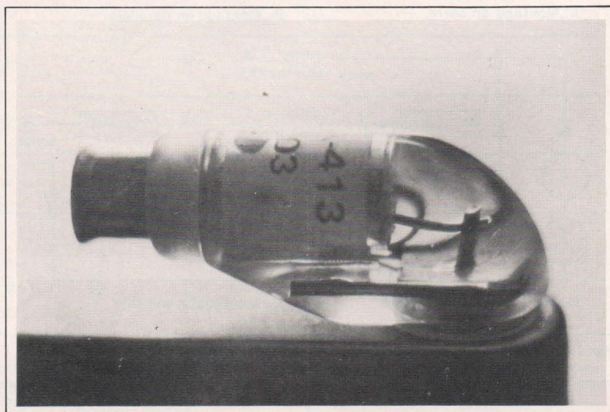
Fig. 25. - Détail du boîtier d'un stimulateur montrant la protubérance assurant le montage étanche de l'électrode (doc. Pacesetter-CGR).
