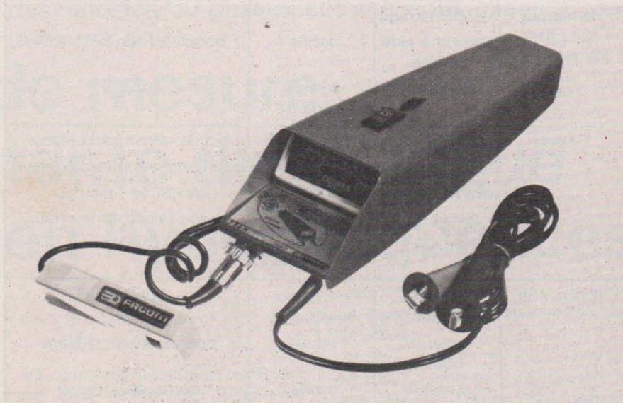
Un stroboscope à déphasage. L'avance se lit directement en degrés sur le cadran après réglage de la molette de déphasage (cliché Facom).
