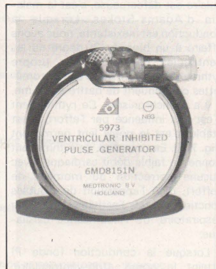
Fig. 14. – Pacemaker inhibé par l'onde QRS (doc. Medtronic).
