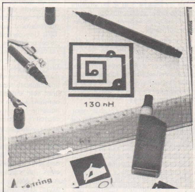
Un matériel de dessin très courant suffit pour réaliser des originaux très corrects.
